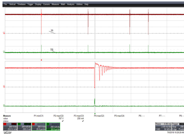
Figure 31 – 420 VAC, 50 Hz. CH2: V_{DS} , 200 V / div., 2 ms / div. CH3: I_{DS} , 200 mA / div., 2 ms / div. Zoom: 100 \mu s / div. V_{DS(MAX)} : 767 V. I_{DS(MAX)} : 250 mA.
