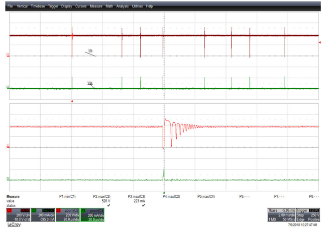
Figure 30 – 265 VAC, 50 Hz. CH2: V_{DS} , 200 V / div., 2 ms / div. CH3: I_{DS} , 200 mA / div., 2 ms / div. Zoom: 1 ms / div. V_{DS(MAX)} : 528 V. I_{DS(MAX)} : 223 mA.
