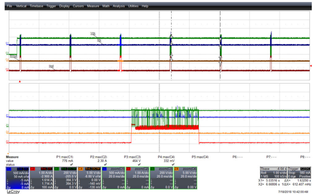
Figure 92 – 265 VAC, 50 Hz. Ch1: I_{D_S} , 500 mA / div., 1 s / div. Ch2: 12 V I_{O_{UT}} , 1 A / div., 1 s / div. Ch3: V_{D_S} , 200 V / div., 1 s / div. Ch4: 5 V O_{UT} , 5 V / div., 1 s / div. Zoom: 20 ms / div. Auto-restart ON Time: 44 ms. Auto-restart OFF Time: 1.63 s.
